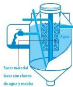
Limpieza del tanque
